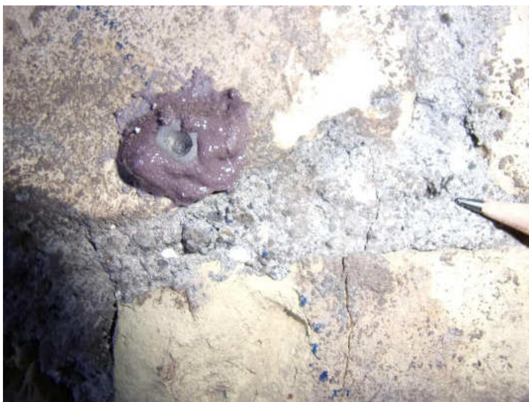
PROVA M1: particolare delle lesioni in seguito a rottura.
